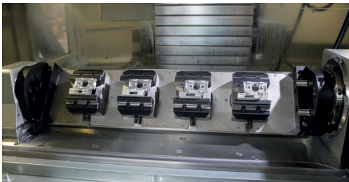
Für die sukzessive 4-Achsen-Bearbeitung gleicher oder unterschiedlicher Werkstücke kann die Schwenktisch-Grundplatte mit vier Gressel-Zentrisch-Spannern C2 125 bestückt werden.
